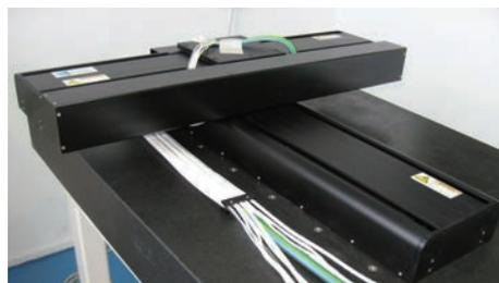
另外一种配置时将XY轴分离，其中上端的轴安装在固定的横梁上。这种案例中，下部的轴携带被加工件在一个方向上运动，上轴携带执行机构在正交的方向上运动。（如右图所示）
